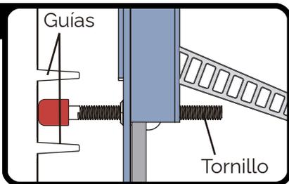
Al momento de colocar la tapa, verificar que el tornillo queda ubicado entre las dos guías de la parte posterior de la tecla.
