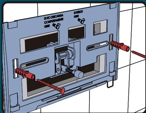
1. En caso de no tener ningún tipo de fijación, utilizar tornillo y tarugo provistos en el empaque
